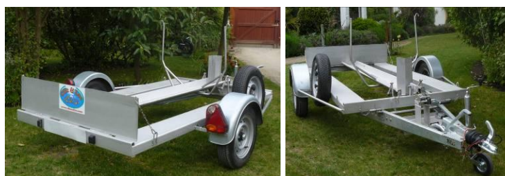
Ici en version 500 Kg freiné avec treuil manuel, roue jockey et roue de secours.
